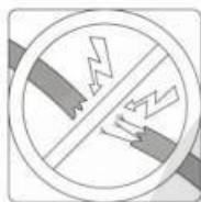
Controllare i cavi danneggiati
