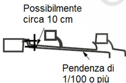
Metodo per il collegamento centralizzato delle tubazioni di scarico dell'acqua
