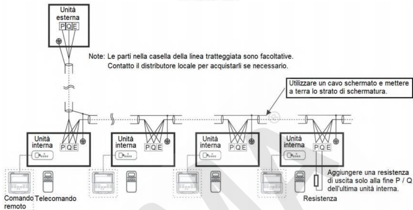
Cablaggio dell'unità interna e del controllo dell'unità esterna
