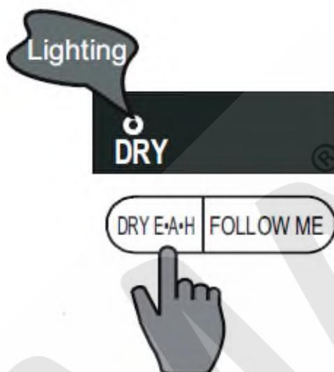
Questo telecomando ha la funzione asciugatura della batteria, quando l'unità è in modalità di raffreddamento o di deumidificazione, il condizionatore opererà automaticamente la funzione asciugatura, quindi l'icona verrà illuminata. Per i modelli con solo la modalità raffreddamento, basta far funzionare la ventilazione per 10 minuti e quindi spegnere automaticamente l'unità
