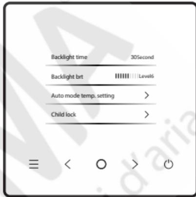
Il tempo di retroilluminazione può essere impostato su 15s, 30s o 60s. Dopo l'impostazione, se il dispositivo non riceve alcun comando entro il tempo di retroilluminazione impostato, passa all'interfaccia di standby. È possibile premere "○" per regolare la durata della retroilluminazione.
