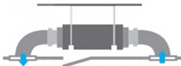
Presca d'aria posteriore e mandata diretta (STANDARD)
