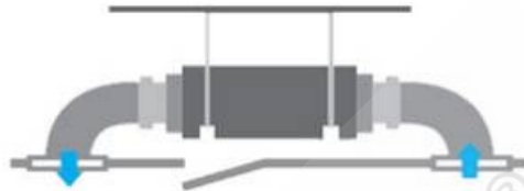
Presa d'aria posteriore e mandata diretta (STANDARD)
