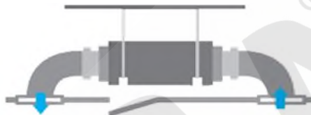
Presa d'aria posteriore e mandata diretta (STANDARD)
